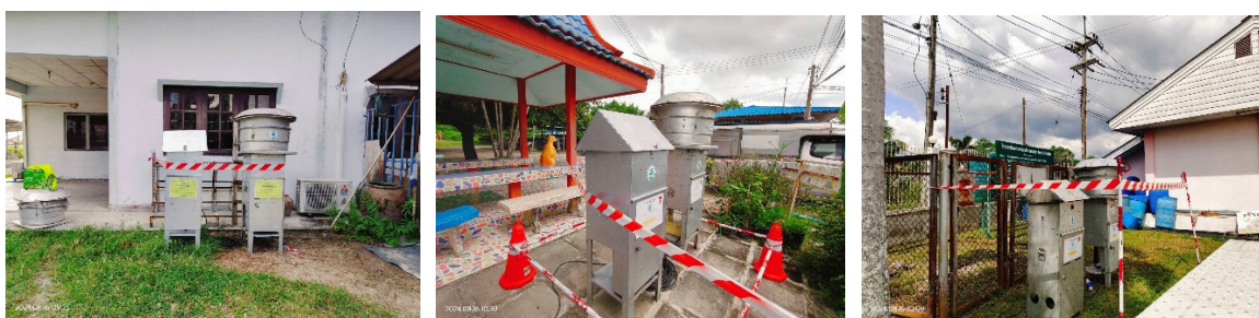
ภาพที่ 3.3.2 ภาพการเก็บตัวอย่างคุณภาพอากาศในบรรยากาศ
